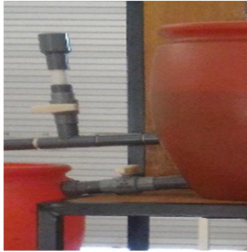
Gambar 14. Valve Penghubung antar Tangki
