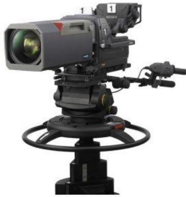
Gambar 1.7. Kamera pada Lab Broadcasting dengan tipe Sony HDC-2000 [5]
