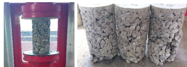
Gambar 2. Settingan pengujian kuat tekan dan pola retak beton berpori
