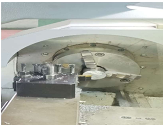
Gambar 4. Pembubutan pada bagian muka ( facing )
