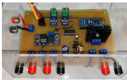
Gambar 6. Rangkaian Buckboost Converter pada Sistem
