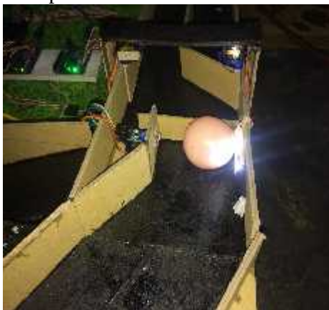
Gambar 22. Telur Melewati Sensor Pendeteksi Kualitas
