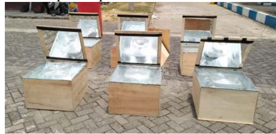
Gambar 3. Kompor Surya Tipe Kotak dengan Variasi Sudut Ruang Masak
