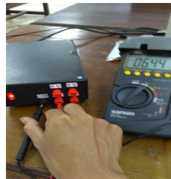
Gambar 6. Percobaan Tegangan 6V Posisi Terminal Atas
