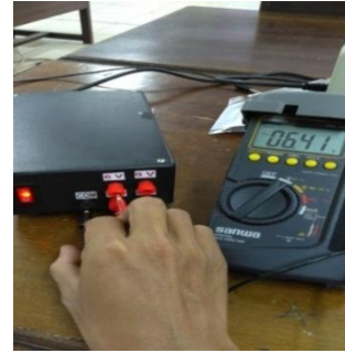
Gambar 4. Percobaan Tegangan 6V Posisi Terminal Bawah
