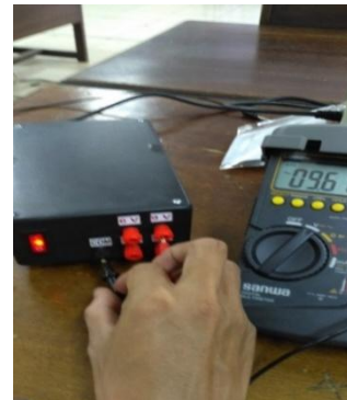
Gambar 5. Percobaan Tegangan 9V Posisi Terminal Bawah
