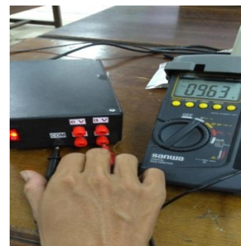
Gambar 6. Percobaan Tegangan 6V Posisi Terminal Atas
