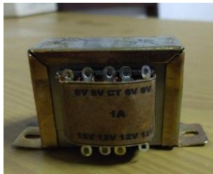
Gambar 3. Trafo CT 1A
