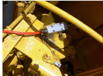
Gambar 17. Differential pressure Switch terpasang pada HPF.
