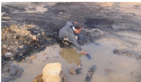
Foto 4.5. Foto Pengambilan sampel air permukaan dilokasi pengamatan Balikpapan Regency (AL-Balikpapan Regency).
