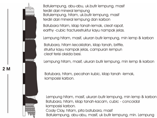
Gambar 4. 2. Profil singkapan Batubara di Lokasi Pengamatan Balikpapan Regency
