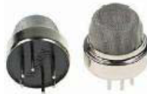
Gambar 1 Bentuk Gas Sensor HS 133 (Sumber : Sencera Co. Ltd)
