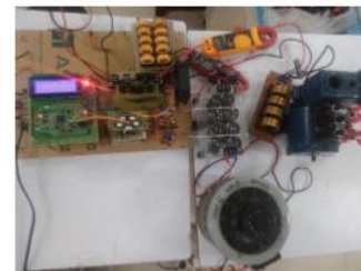
Gambar 9. Kondisi Pengujian Z-source Inverter
