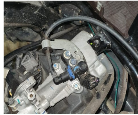
Gambar 3 Hos/line dari pressure gauge ke injektor
