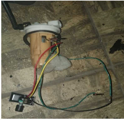
Gambar 1 fuel pump yang terpasang potensio
