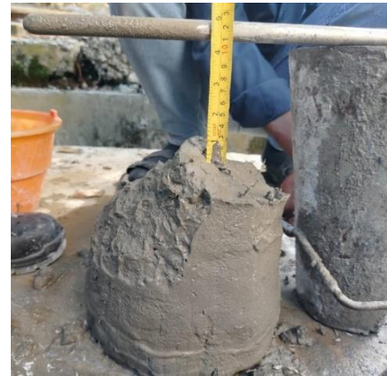
Gambar 5. Pengujian Slump BS
