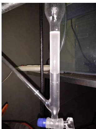
Gambar 11. Perolehan minyak serai wangi pada tahap penyulingan
