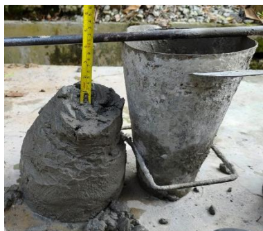
Gambar 4. Pengujian Slump BN
