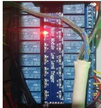
Gambar 7. Pengendalian Relay untuk mengaktifkan solenoid push pull
