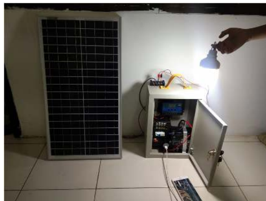
Gambar 4. Pengujian alat mini PLTS yang dibuat
