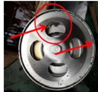
Gambar 5. Kondisi return filter
