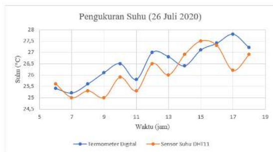
Gambar 19. Pengukuran suhu hari pertama pada ruang server
