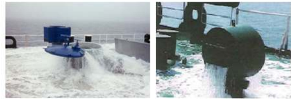
Gambar 1. Luapan air ballas pada dek kapal
