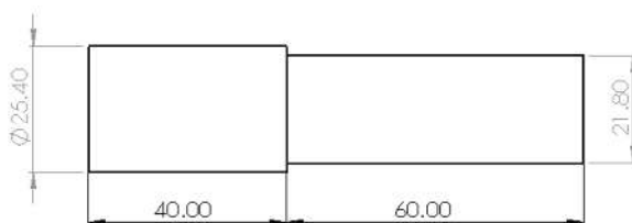
Gambar 2. Panjang pembubutan pada spesimen.
