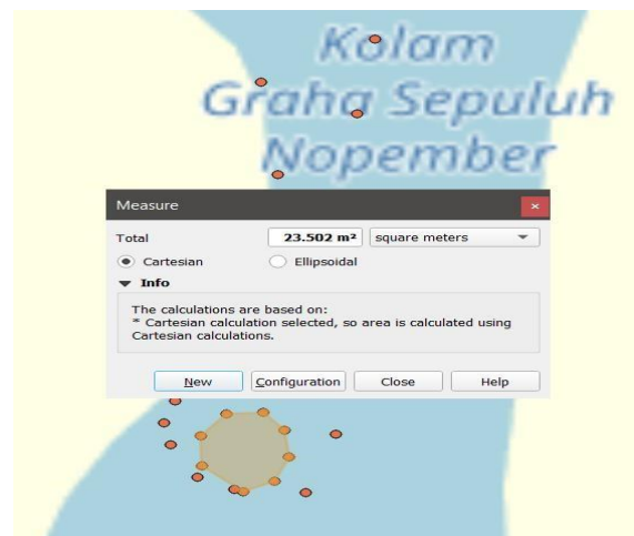
Gambar 8. Hasil Plotting pada Uji Gerak Melingkar Menggunakan Software QGIS
