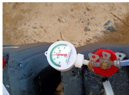
Gambar 3. Nilai tekanan biogas pada alat ukur pressure gauge
