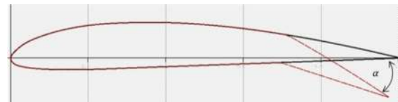
Gambar 2. Defleksi airfoil pada trailing edge
