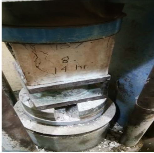
Gambar 2. Pengujian Kuat Tekan pada Benda Uji
