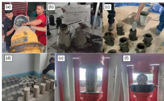
Gambar 2. Pembuatan dan pengujian beton: (a) proses mixing, (b) slump test, (c) casting, (d) perawatan benda uji, (e) uji tekan beton, dan (f) uji tarik belah beton
