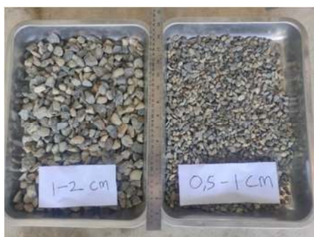
Gambar 1. Agregat kasar ukuran 1.0~2.0 cm dan 0.5~1.0 cm
