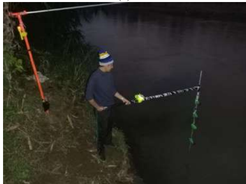
Gambar 3. Pengukuran Hidrometri Sungai (a) Dengan Tripod dan (b) Tanpa Tripod
