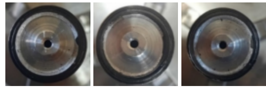
Gambar 8. Pola hasil lukisan uji simulasi pengelasan kapsul iradiasi
