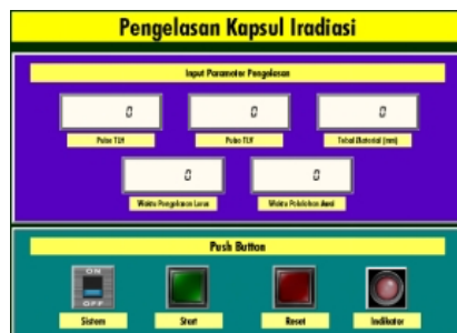
Gambar 7. Panel HMI untuk operasi pengelasan kapsul
