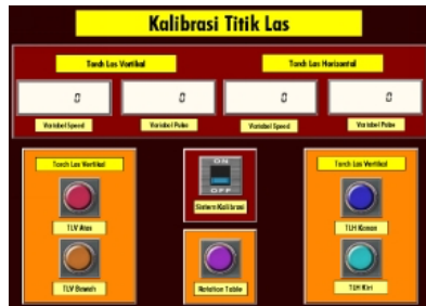
Gambar 6. Panel HMI untuk kalibrasi titik pengelasan
