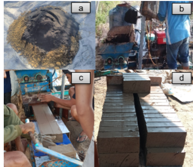
Gambar 3. Proses pembuatan batu bata basah
