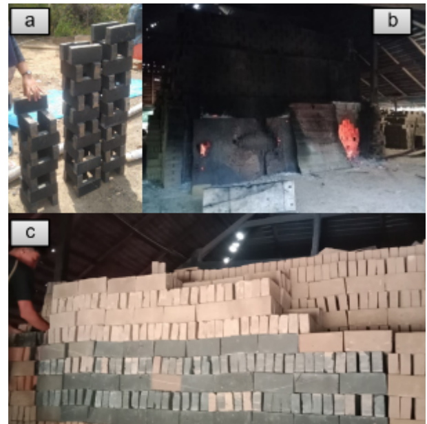
Gambar 4. (a) Pengeringan benda uji batu bata dengan sinar matahari, (b) Proses pembakaran (c) Benda uji batu bata setelah dibakar di kiln
