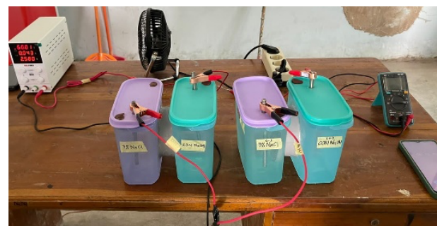
Gambar 4. Skema pengukuran RCPT
