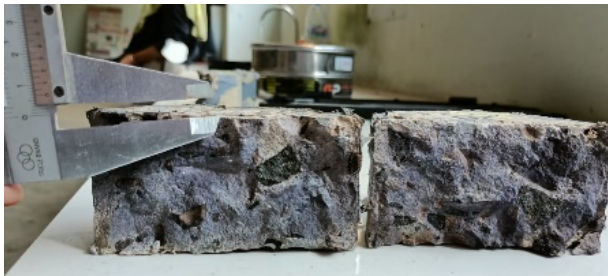
Gambar 5. Pengukuran rata-rata kedalaman penetrasi klorida
