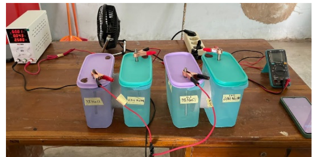
Gambar 4. Skema pengukuran RCPT
