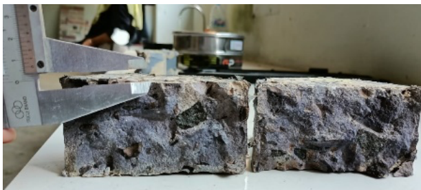
Gambar 5. Pengukuran rata-rata kedalaman penetrasi klorida
