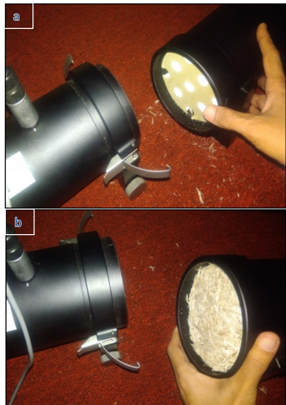
Gambar 3. (a) Sampel bulu ayam dengan lapisan gypsum (b) Sampel bulu ayam tanpa gypsum
