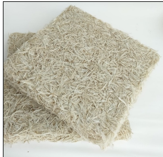
Gambar 1. Varian material dengan densitas 250\text{kg/m}^3 dan 350\text{kg/m}^3 .
