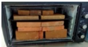
Gambar 4. Pengovenan benda uji selama 24 jam
