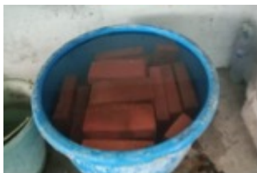
Gambar 3. Perendaman benda uji selama 24 jam
