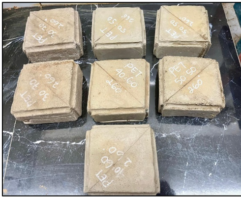
Gambar 4. Sampel Paving Block Dengan Campuran Plastik PET
