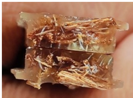
Gambar 3. Spesimen setelah dilakukan uji Tarik
