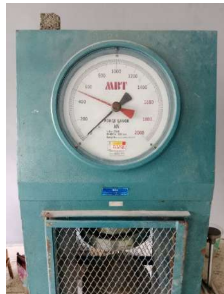
Gambar 3. Pengujian Kuat Tekan Menggunakan Compression Machine Analog
