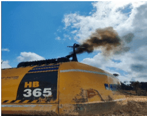
Gambar 5. Blacksmoke pada muffler
