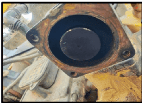
Gambar 9. Kondisi EGR valve
