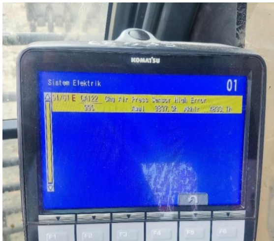
Gambar 4. Failure code pada monitor panel
