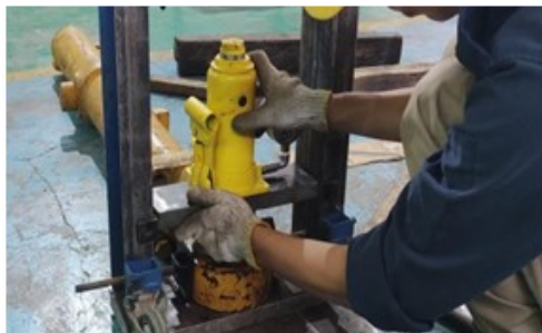
Gambar 20. Pemasangan hydraulic jack
