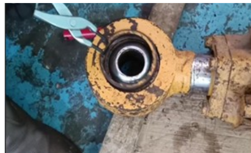
Gambar 23. Pemasangan snap ring dari sisi lain
