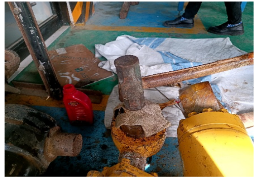
Gambar 1. Proses pemasangan menggunakan pemukulan
