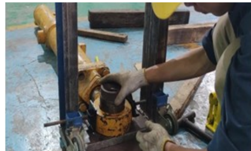
Gambar 18. Pemasangan bushing bekas
