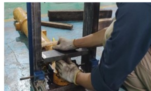
Gambar 19. Pemasangan pressing plate
