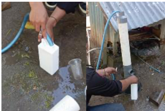
Gambar 4. Pengambilan sampel sebelum dan setelah penyaringan
