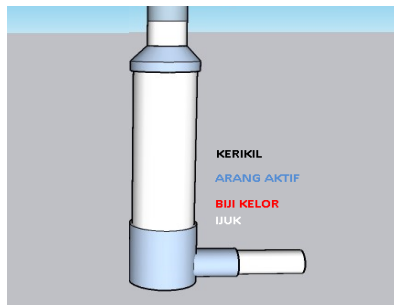
Gambar 3. Model Sistem Penyaringan
