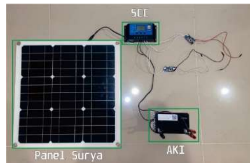
Gambar 5. Menghubungkan panel surya dan aki dengan SCC
