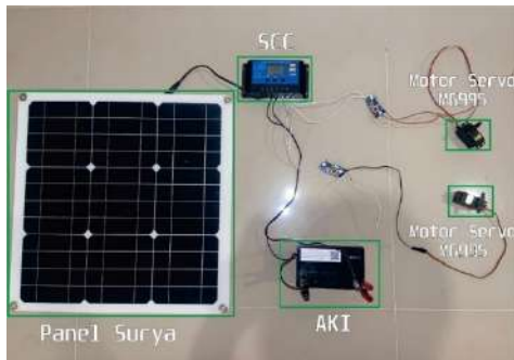
Gambar 6. Menghubungkan motor servo dengan SCC
