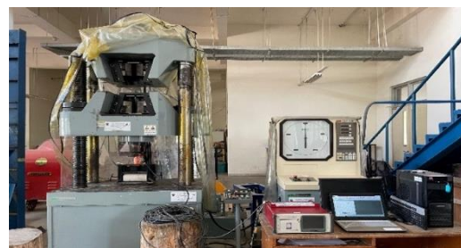
Gambar 3. Pengaturan pengujian benda uji beton
