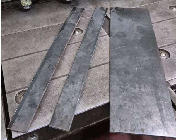
Gambar 8. Hasil pemotongan pelat 5mm
