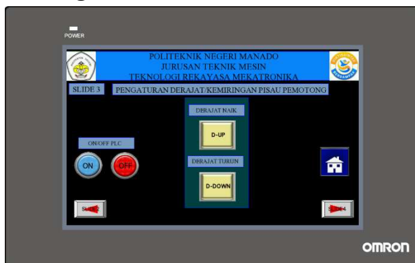
Gambar 4. HMI Omron NB7W untuk mengatur sudut kemiringan pisau serta mengontrol pompa hidrolik.
