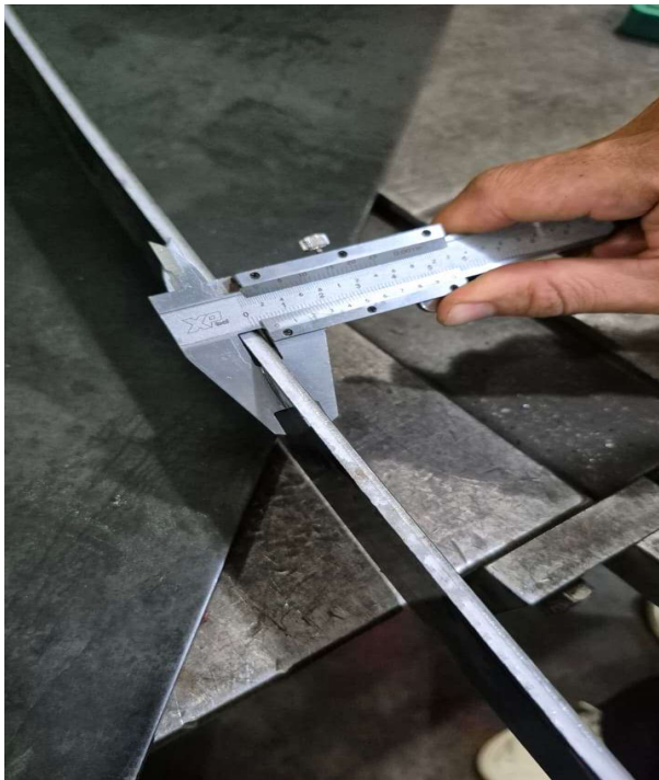
Gambar 9. hasil pemotongan dan pengukuran ketebalan pelat yang dipotong
