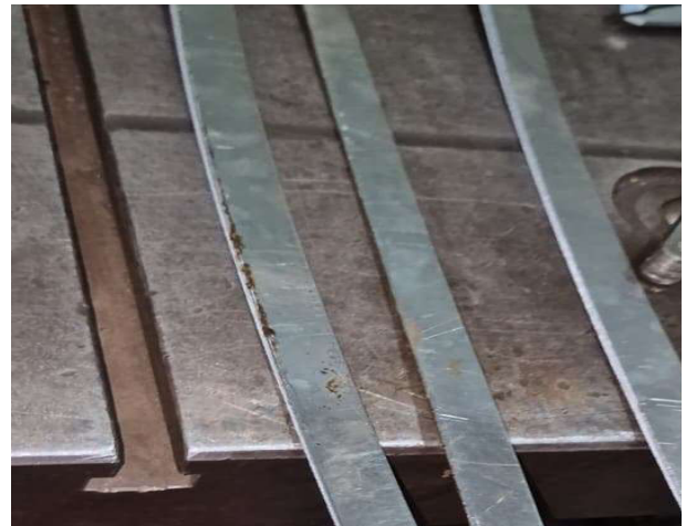
Gambar 10. Hasil pemotongan pelat stainless 2mm
