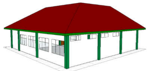
Gambar 6. Penambahan ventilasi pada ruang
