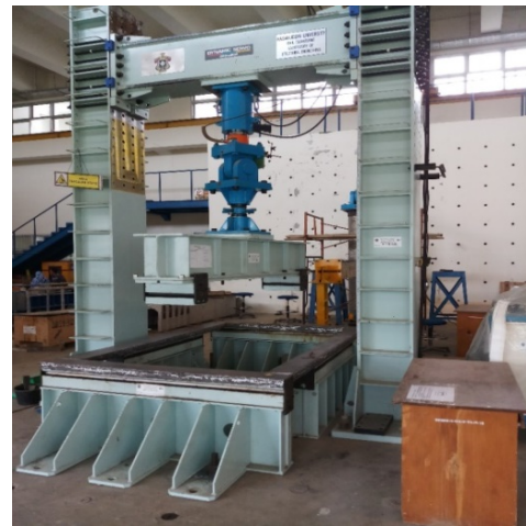
Gambar 7. Setting sendi dan frame load
